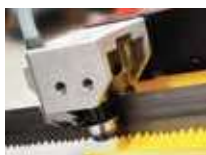
Sägebandführung aus Hartmetall
