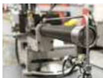
Vollhubzylinder des Spannstocks (Option)
